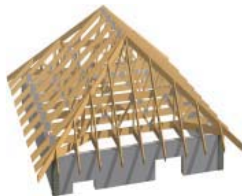
W domach szkieletowych lub z bali więźba dachowa jest zwykle tradycyjna (rys. Mabudo)
