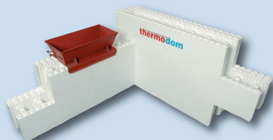
▲ Styropianowe kształtki tworzą tzw. deskowanie tracone, które zostanie wypełnione mieszanką betonową. Po związaniu betonu styropian będzie pełnił funkcję izolacji cieplnej
