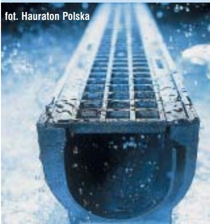
Długość korytek wynosi zwykle 50 lub 100 cm, a szerokość 10 cm (dostępne są też korytka szerokości do 68 cm). Mogą mieć dno płaskie lub ukształtowane ze spadkiem. Korytka z płaskim dnem stosujemy w lekko nachylonym terenie, do budowania odwodnień kaskadowych lub do odwadniania niewielkich powierzchni – długości maks. 5-10 m.
