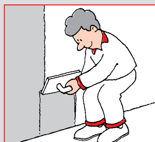
Nakładać szeroką stalową pacą.
