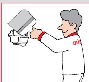
Najpierw zaszpachlować pęknięcia i ubytki w podłożu.
