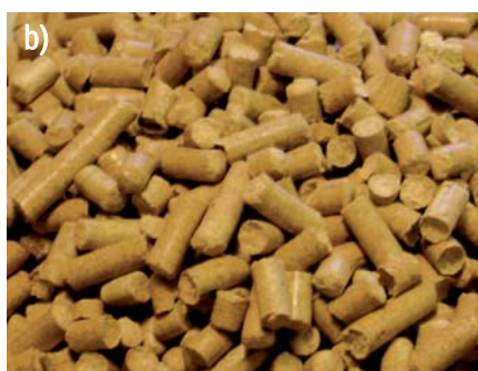
1 a – brykiety (fot. Drewnexpol) i b – pelety (fot. Bio-Pelet Polskie Paliwa Ekologiczne) są coraz częściej stosowane. Mają standardowe wymiary i nie trzeba ich dosuszać ▲
