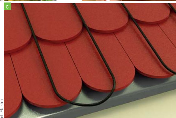
▲ Do rynien PVC montowanych na terenach o silnych opadach śniegu dodatkowo trzeba będzie dokupić płotki przeciwnieżne (a) lub kable grzewcze, montowane w rynnach i rurach spustowych (b) lub na pości dachu (c)
