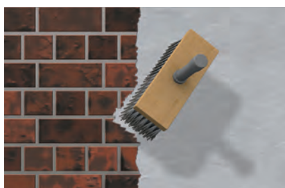
1. Wyrównywanie powierzchni ścian
