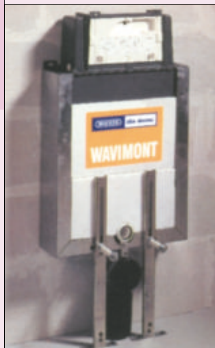
4 W skład stelaża instalacyjnego do WC wchodzi metalowa rama z zamontowanym zbiornikiem spłukującym oraz niezbędne przyłącza. Styropianowa obudowa spłuczki ogranicza hałas (fot. Wavin)
