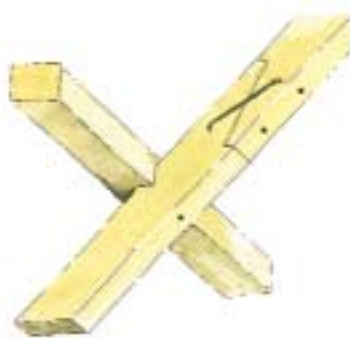
13 Łączenie krokwi nad płatwią pośrednią: a) mijankowo, b) na zamek z nakładkami
