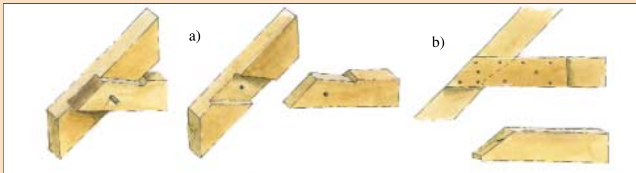
17 Połączenie krokwi z jętką: a) na wręb z kołkiem („półjaskółczy ogon”), b) z dwustronnymi nakładkami
