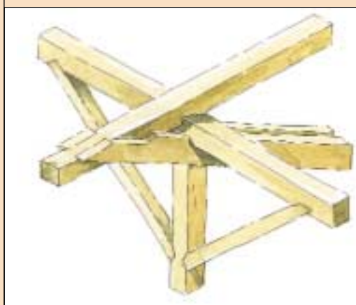
18 Połączenie kleszczy ze słupkiem
