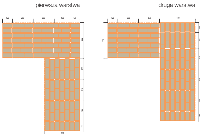
połączenie Porotherm 44 T Profi / Dryfix w narożniku
