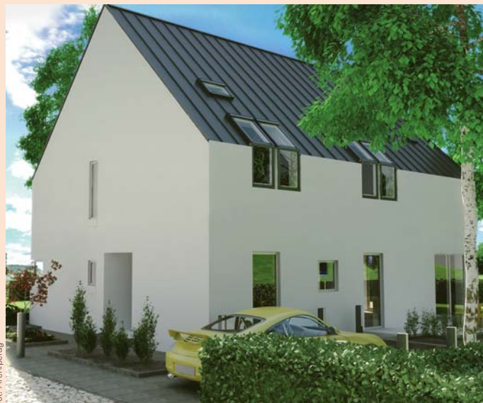
Budynek by był energooszczędny powinien mieć zwartą bryłę bez wykuszy, lukarn i balkonów oraz ergonomiczne rozplanowane wnętrza
