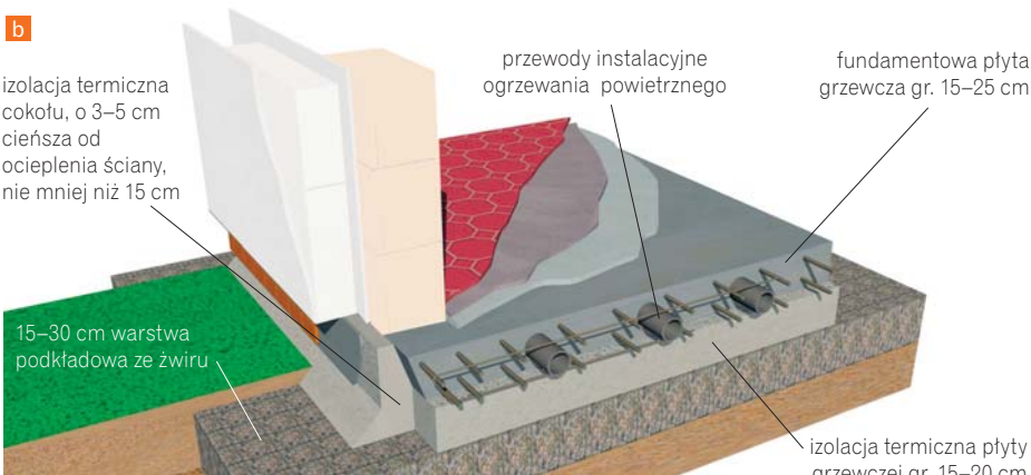
Płyta fundamentowa z ogrzewaniem wodnym (a) (zasilanym np. pompą ciepła) i powietrznym (b)
