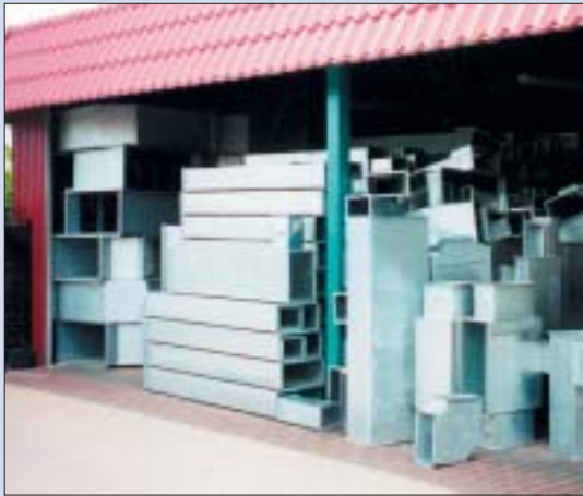
14 Kanały z blachy ocynkowanej (fot. Z.P.U.H. Stefan Żok)
