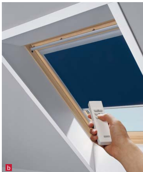
▲ Ostony okienne można opuszczać i podnosić ręcznie (a) lub np. pilotem (b) – przez sterowanie radiowe. Przy rozwiązaniu drugim każda osłona wyposażona jest w odbiornik, do którego docierają sygnały wysyłane za pomocą pilota bądź innego układu sterującego. Roletami można sterować centralnie lub każdą oddzielnie
