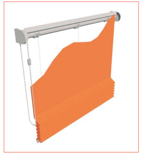
▲ Pojedyncza roleta rzymska. Umieszczona na rolce nawojowej porowata listwa umożliwia doczepienie odpowiedniego materiału miękkim rzepem. Roleta jest podnoszona za pomocą mechanizmu łańcuszkowego powodującego ruch rury nawojowej – ta nawija sznurki zasłony na specjalne szpulki – w ten sposób materiał się podnosi
