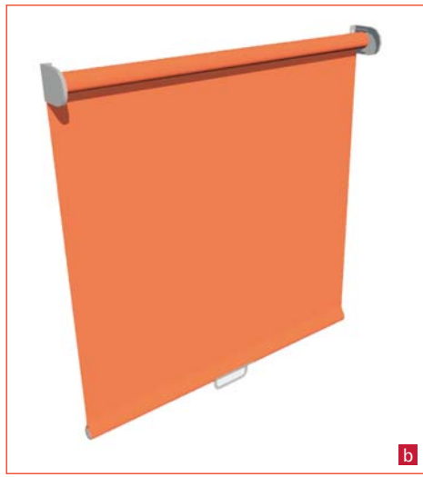
▲ Rolety zwijane: (a) łańcuszkowa, b) sprężynowa. Opuszczanie i podnoszenie rolety (a) odbywa się przez ciągnięcie łańcuszka napędowego. Ruch rolety (b) możliwy jest dzięki uchwytowi obsługowemu, umieszczonemu na listwie zakończającej materiał; system sprężyn i sznurków napinających zatrzymuje roletę w pożądanej pozycji
