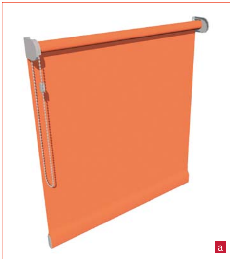
▲ Rolety zwijane: (a) łańcuszkowa, b) sprężynowa. Opuszczanie i podnoszenie rolety (a) odbywa się przez ciągnięcie łańcuszka napędowego. Ruch rolety (b) możliwy jest dzięki uchwytowi obsługowemu, umieszczonemu na listwie zakończającej materiał; system sprężyn i sznurków napinających zatrzymuje roletę w pożądanej pozycji
