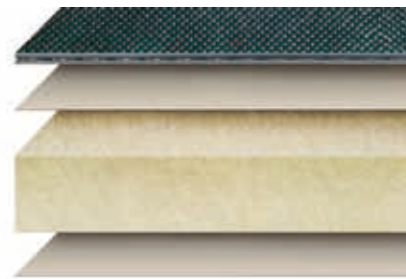
BauderPIR SDS (WLS 028) z obustronną włókniną mineralną oraz dyfuzyjną papą polimerobitumiczną po stronie wierzchniej
