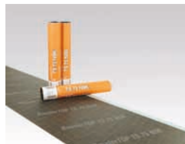
BauderTOP TS 75 NSK – Samoprzylepna papa podkładowa jako bezpieczny podkład i warstwa paroszczelna pod płytę BauderPIR MDE, do montażu na deskowaniu
