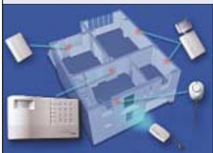
5 Na system alarmowy składają się czujniki chroniące poszczególne strefy w domu (fot. Sowa)
