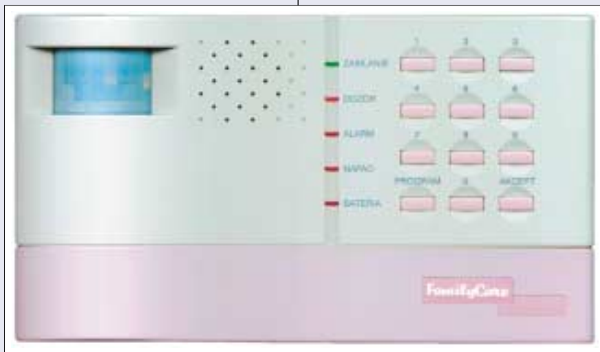
3 Centrala jest sercem systemu alarmowego (fot. Sowa)
