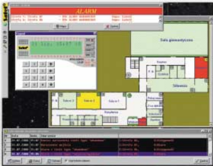
8 Komunikat o alarmie pojawia się na ekranie monitora w centrum monitoringu (fot. Satel)
