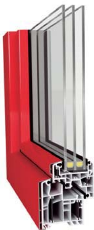
energeto® 5000, system o głębokości zabudowy 70 mm z uszczelnieniem środkowym, z nakładkami aluminiowymi
