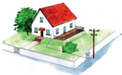
Przyłącze kablowe z linii napowietrznej
