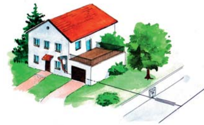
Przyłącze kablowe z linii kablowej
