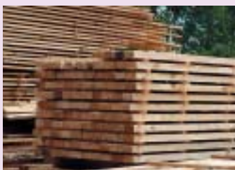
Po impregnacji przez zanurzenie suszymy drewno w luźnych stosach (fot. Petrykozy)
