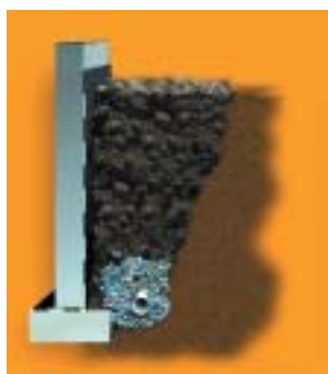
Przekrój przez drenaż (fot. Wavin Metalplast Buk)
