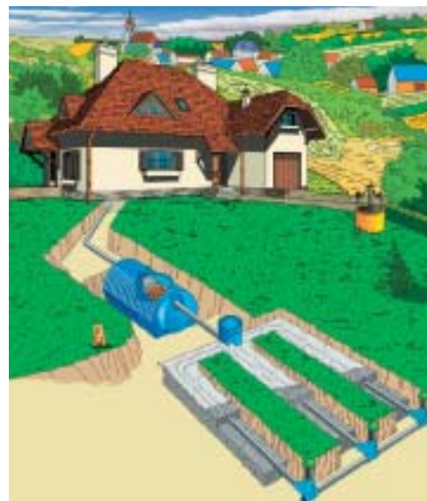
Schemat przydomowej oczyszczalni ścieków z drenażem rozsączającym (fot. JPR System)
