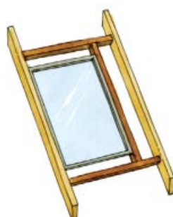
zastosowanie wymianów – okno znacznie mniejsze lub większe od rozstawu krokwi
