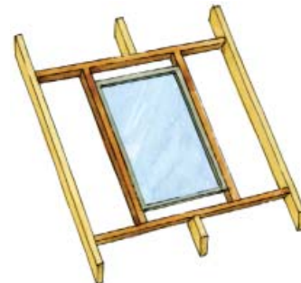
zastosowanie wymianów – okno znacznie mniejsze lub większe od rozstawu krokwi
