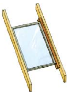
pogrubienie krokwi – okno nieznacznie mniejsze od ich rozstawu
