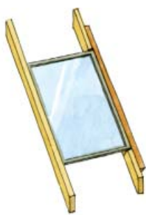
nadbicie wyciętej krokwi – okno nieznacznie większe od ich rozstawu
