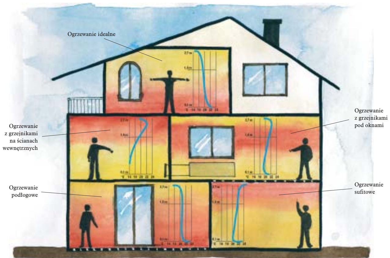
14 Pionowy rozkład temperatury w pomieszczeniach z różnymi systemami ogrzewania (rys. Aquatherm)
