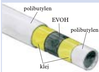
A Rura grzejna z polibutylenu, zaopatrzona w warstwę tleno-szczelnego tworzywa EVOH
