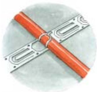
18 Mocowanie kabla grzejnego w taśmie montażowej
