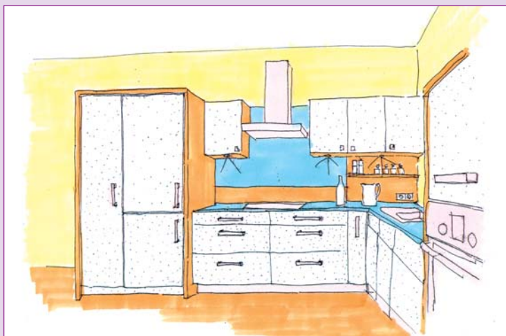
Zabudowa otwartej kuchni w kształcie litery L. Ciąg roboczy ograniczają szafy ujęte w drewniane ramy, a w nich lodówka i cargo na jednym końcu i słup z piekarnikiem na drugim
