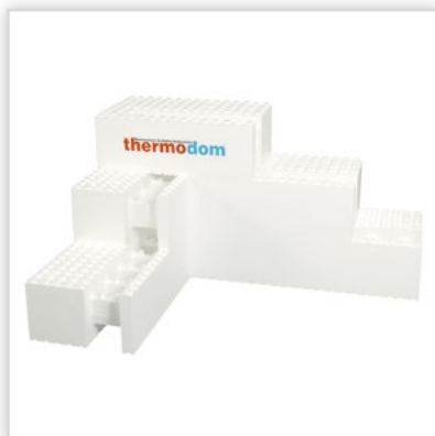
System ścienny TH450. Elementy do wznoszenia ścian budynków energooszczędnych i pasywnych. Doskonały współczynnik przenikania ciepła U_0 [W/m 2 K]: 0,1. Grubość ścian [cm]: 45. Zużycie betonu [m 3 /m 2 ]: 0,122. Aprobaty: Europejska Aprobata Techniczna. Cena netto [zł/m 2 ]: 184.
