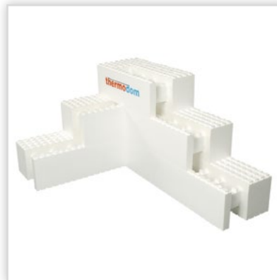
System ścienny TH400. Elementy do wznoszenia ciepłych ścian budynków energooszczędnych i pasywnych. Doskonały współczynnik przenikania ciepła U_0 [W/m 2 K]: <0,13. Grubość ścian [cm]: 40. Zużycie betonu [m 3 /m 2 ]: 0,122. Aprobaty: Europejska Aprobata Techniczna. Cena netto [zł/m 2 ]: 164.
