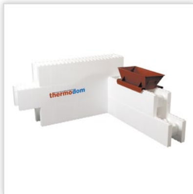
System ścienny TH250. Elementy do wznoszenia ciepłych ścian budynków energooszczędnych, ścian fundamentowych i niecek basenowych. Doskonały współczynnik przenikania ciepła U_0 [W/m 2 K]: 0,28. Grubość ścian [cm]: 25. Zużycie betonu [m 3 /m 2 ]: 0,122. Aprobaty: Europejska Aprobata Techniczna. Cena netto [zł/m 2 ]: 89.
